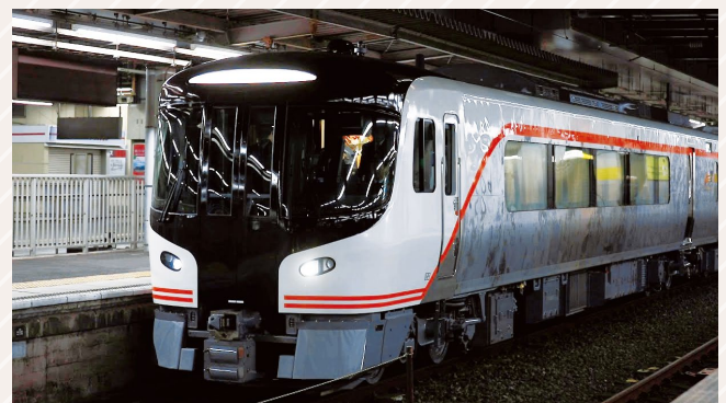
エンジンで発電しモーターで走るディーゼルカーHC85系の試作車
